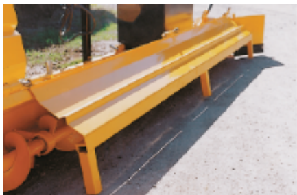
Pantalla protectora conformada; para inicio de trabajo, por debajo del cereal.
